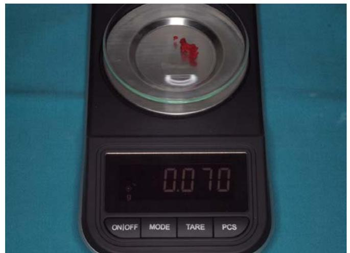
Figura 2: Obtención del peso de las virutas de hueso recolectadas en báscula de alta precisión.
