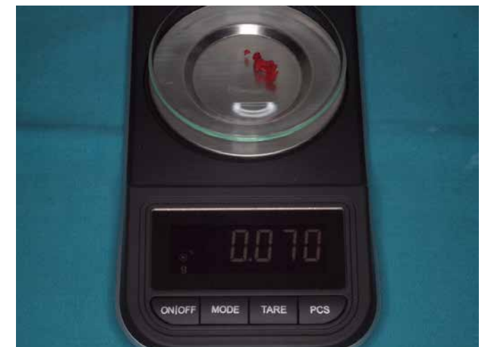
Figura 2: Obtención del peso de las virutas de hueso recolectadas en báscula de alta precisión.
