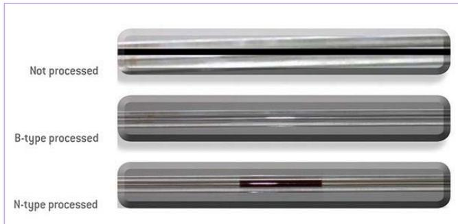
Figura 2. La imagen inferior (ciclo tipo N) muestra que el vapor no pudo eliminar el líquido del centro de la luz del tubo. Esta parte de la superficie interna no se puede esterilizar usando el ciclo tipo N.
