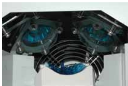
FIGURA 6. POLIMERIZACIÓN EN UNIDAD DE FOTO-POLIMERIZACIÓN, P.EJ SOLIDILITE V (SHOFU).
