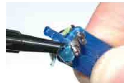
FIGURA 2. REVESTIR EL TORNILLO DE EXPANSIÓN.
